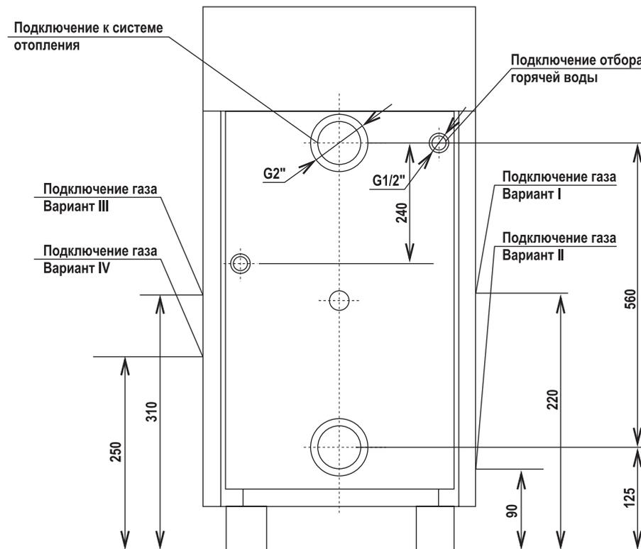
Рис. 7.4. Схема подключения котлов КСГ-31,5; КСГ-40; КСГВ-31,5; КСГВ-40
