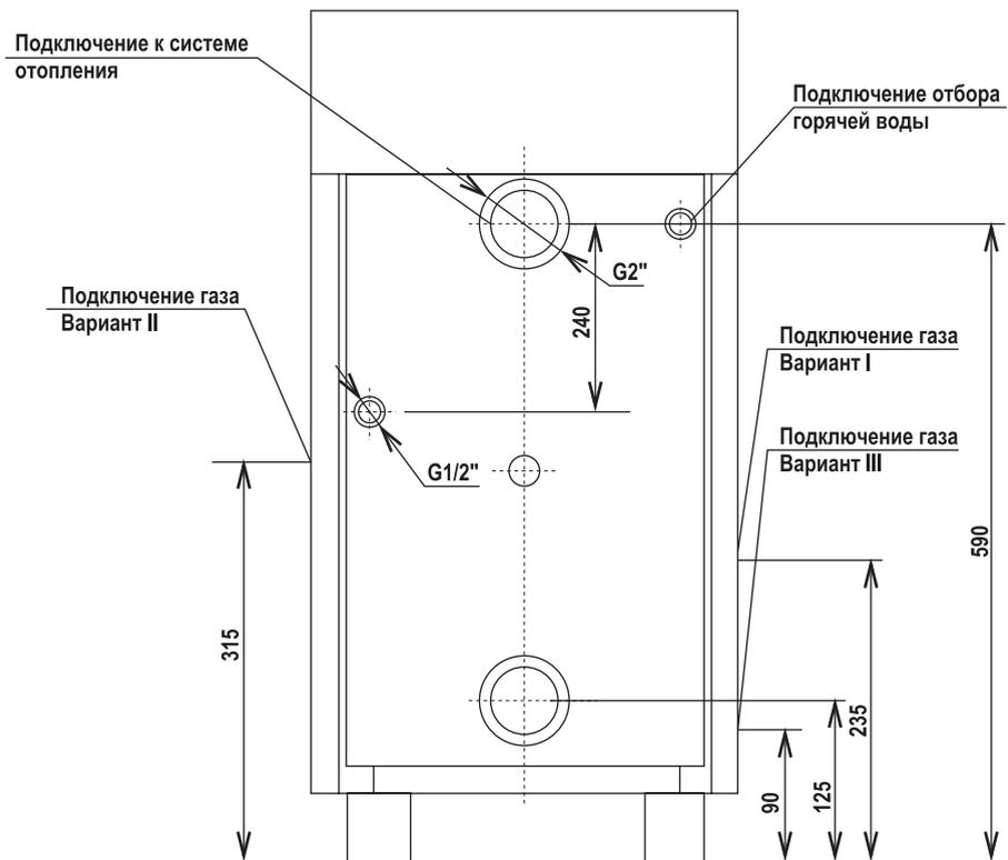
Рис. 7.3. Схема подключения котлов КСГ-16; КСГ-20; КСГВ-16; КСГВ-20
