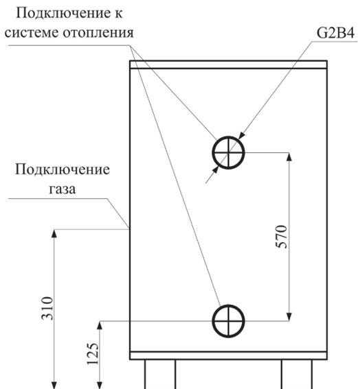
**Рис. 5. Схема подключения котлов КСГ-25; КСГ-31,5;
