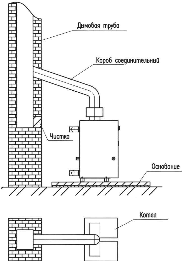
Рис. 8. Схема размещения котлов КСГ-63; КСГ-80; КСГ-100
