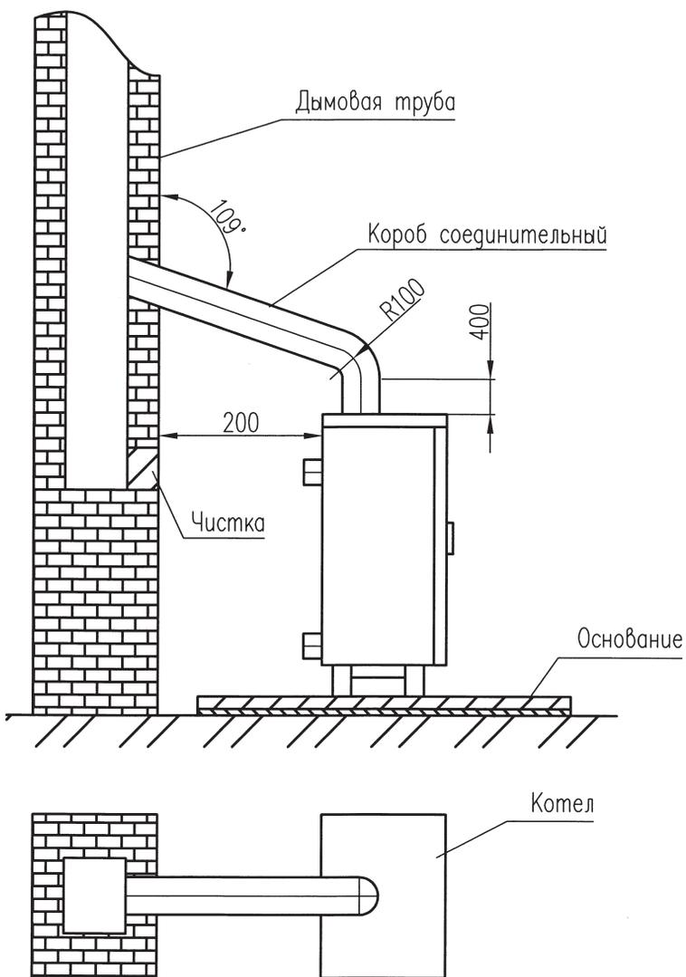
Рис. 1. Схема размещения котлов КСГ-10; КСГ-12,5; КСГ(В)-16; КСГ(В)-20;
