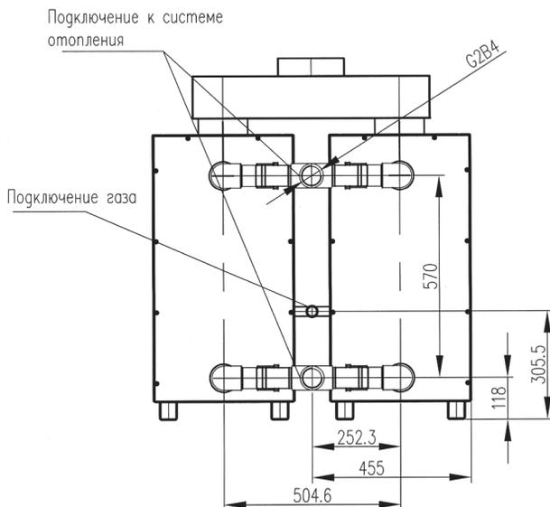
Рис. 7. Схема подключения котлов КСГ-63; КСГ-80; КСГ-100
