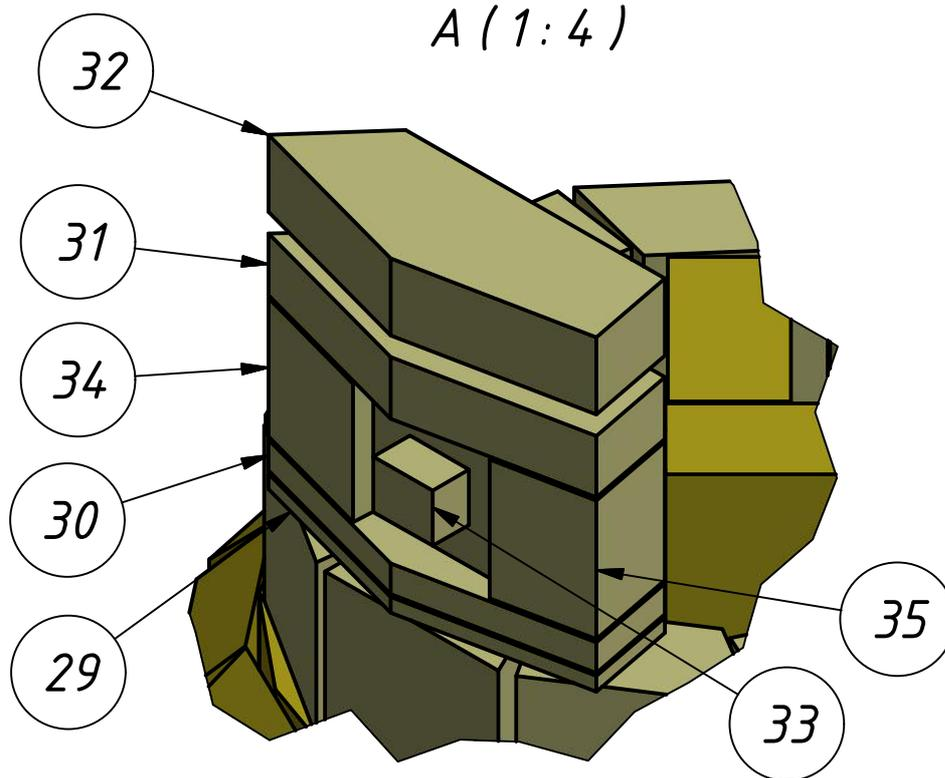
При установке блока чистки комбинируем кирпичи 29, 30, 31 и 32 так, чтобы съёмный элемент 33 оказался по центру прочистного отверстия корпуса.
