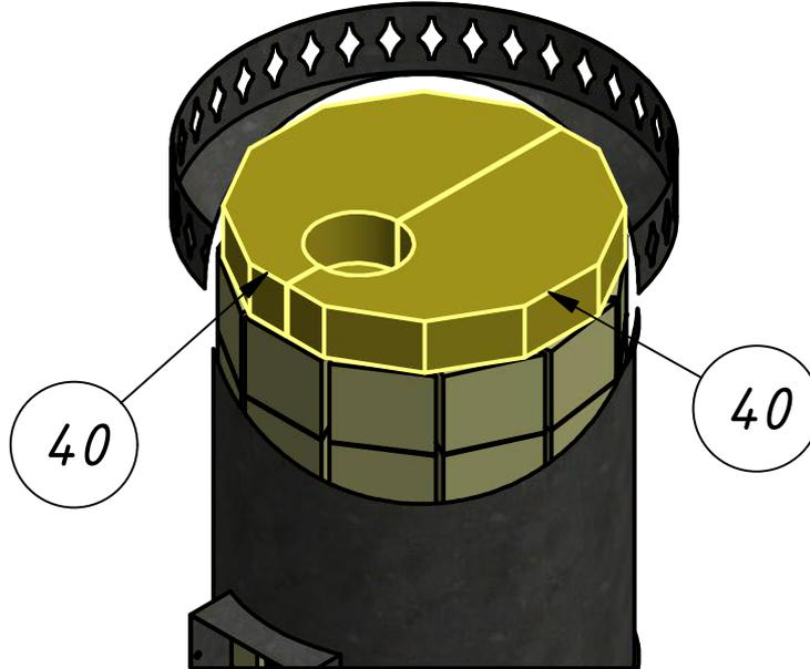
Зазор заполнить обрезками супервула
