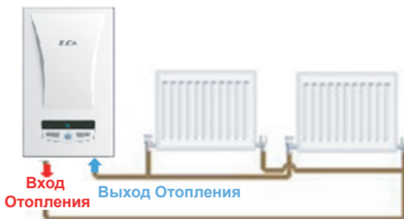
Рисунок 8. Схема подключения устройства СН
