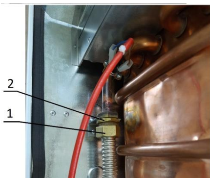
Рис. 19. Демонтаж труб и теплообменника
