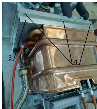
Рис. 19. Демонтаж труб и теплообменника
