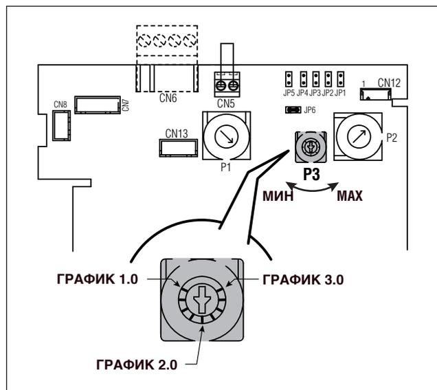
График зависимости заданной температуры в подающем трубопроводе от наружной температуры приведён на Рисунке он приведён для заданной температуры котла 20°C, когда переключатель (1) находится в промежуточном положении.
