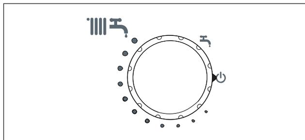
Если есть опасность замерзания, для того, чтобы остались активными автоматические функции защиты от замерзания, оставьте питание на электрическом щитке, для чего должен оставаться включённым главный выключатель системы.
