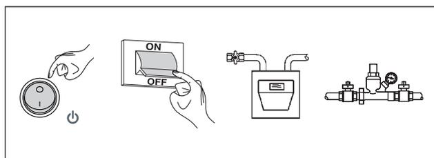
**!** Слейте воду из систем, если существует опасность замерзания. Если это возможно, для удаления воды из контура ГВС используйте сжатый воздух для того, чтобы облегчить данную процедуру, либо обратитесь в Сервисную Службу Сервисному Центру Технического Обслуживания.
