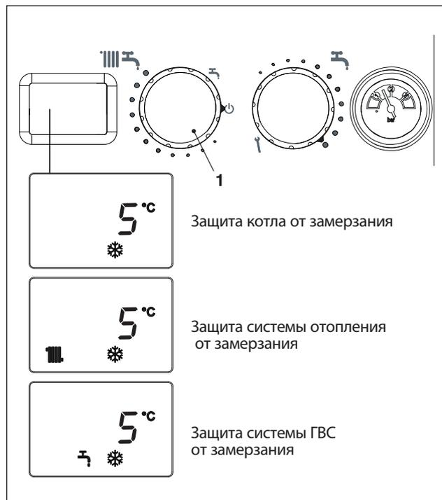
При этом электропитание остаётся подключённым, а трубопровод подачи топлива открытым. Котёл будет защищён следующими функциями:
