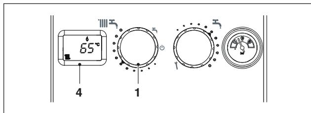
Когда переключатель режимов работы находится в промежуточном положении (1) не происходит корректировки заданной температуры воды в подающем трубопроводе, показанной на схема.
