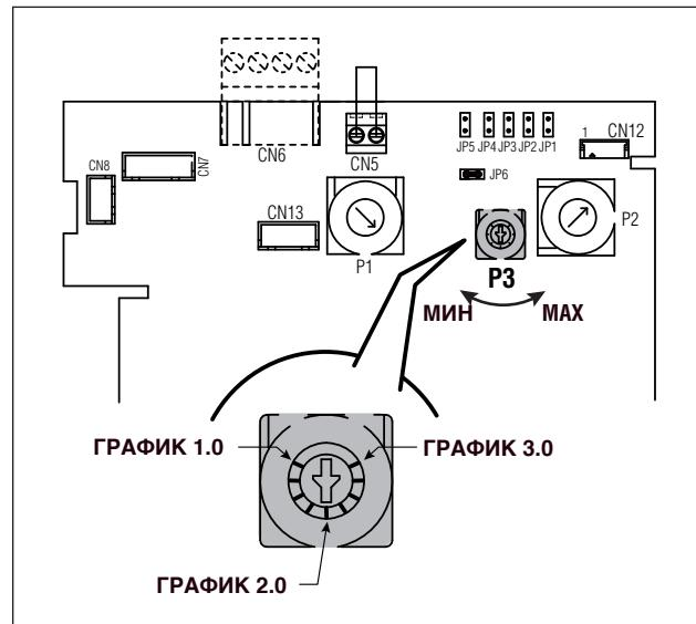
График зависимости заданной температуры в подающем трубопроводе от наружной температуры приведён на Рисунок он приведён для заданной температуры котла 20°C, когда переключатель (1) находится в промежуточном положении.
