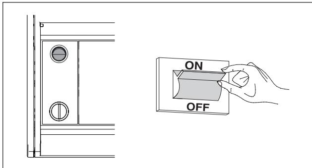
установите терmostат в помещении на требуемую температуру (~20°C), либо, если в системе установлен программируемый таймер или система терморегулирования, убедитесь в том, что она «активирована» и установлена на (~ 20°C).
