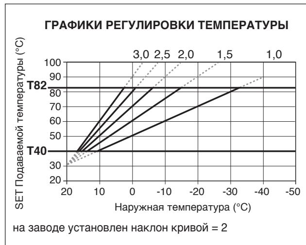
На одной и той же кривой терморегулирования и для той же самой наружной температуры, в случае необходимости, можно изменять заданную температуру котла с помощью переключателя функций (1).
