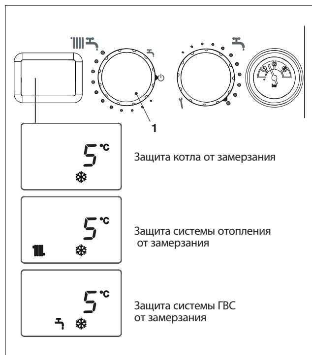
При этом электропитание остаётся подключённым, а трубопровод подачи топлива открытым. Котёл будет защищён следующими функциями:
